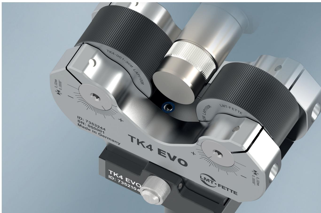
Les têtes à rouler de LMT Fette génèrent en quelques secondes des profils extérieurs de tout type avec une précision élevée grâce au façonnage à froid. Avec les systèmes à rouler les filets, vous disposez en tant qu'utilisateur de nombreux avantages par rapport à l'enlèvement de copeaux : Le temps de fabrication est extrêmement court. De plus, vous obtenez un filet d'une grande solidité avec un respect constant des cotes.
