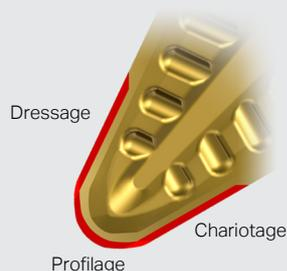
Trois arêtes par pointe. L'usure est répartie sur une plus grande longueur d'arête. Cette configuration permet d'éloigner la chaleur de la zone de coupe.
