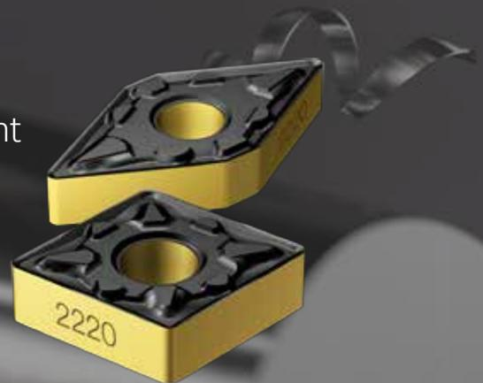
Dotée d'une excellente résistance à la déformation plastique, la nuance de tournage GC2220 est dédiée à l'usinage des aciers inoxydables dans des conditions stables. Le revêtement Inveio™ de la nuance GC2220 offre une résistance à l'usure accrue et prolonge la durée de vie de l'outil, même si les forces de coupe et la température sont élevées.
