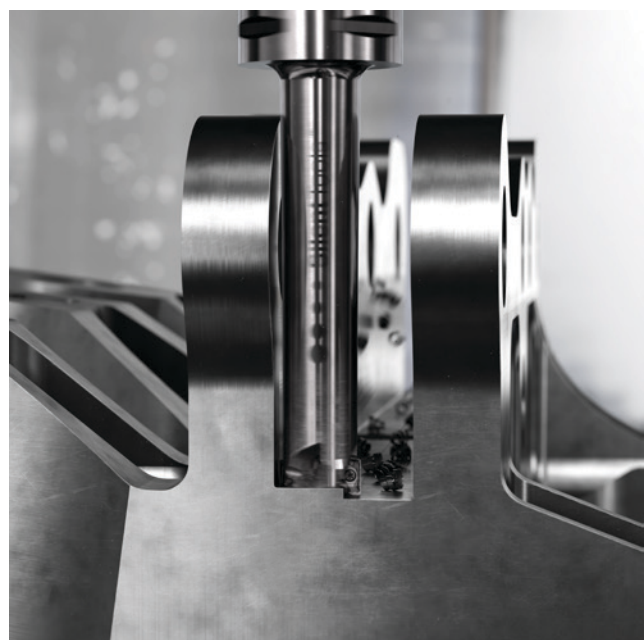
CoroMill 390 convient à de nombreuses applications dont le fraisage d'épaulements et l'usinage de poches. Les fraises sont idéales pour le ramping et l'interpolation hélicoïdale.
