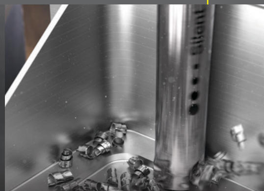
Fraisage d'un bras de train d'atterrissage d'avion en titane avec CoroMill® 390.
